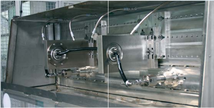
Statische Kraftprüfung sowie dynamische Lastwechselprüfung von Stabilisatoren
